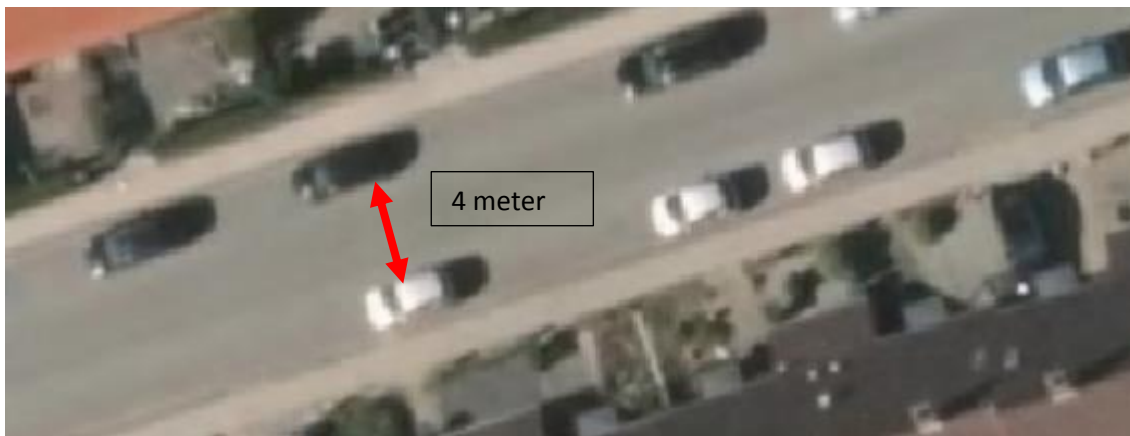
Figur: korrekt fribredde.
